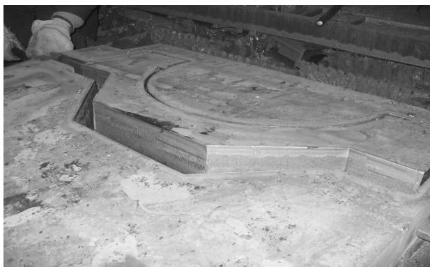
Рис. 6. Поверхность реза при вырезке детали «Корпус подшипника»
