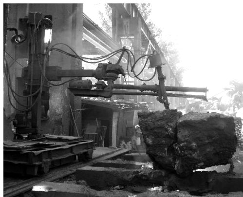
Рис. 2. Машинная резка отхода кузнечного производства толщиной 1200 мм
