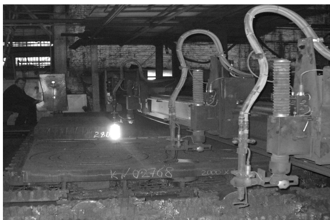
Рис. 5. Вырезка заготовок из плиты толщиной 280 мм на машине с ЧПУ
